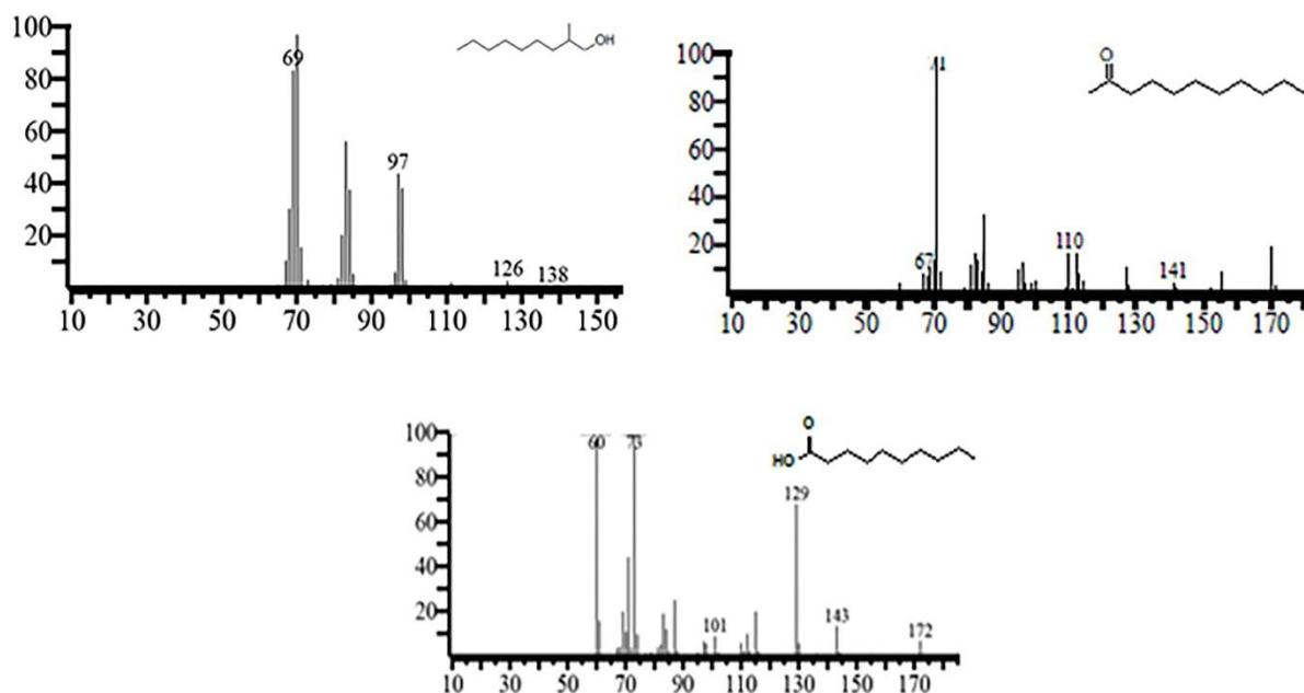
**Figura 1S:** Espectros de massas de *n*-nonanol, undecanona e ácido decanoico
